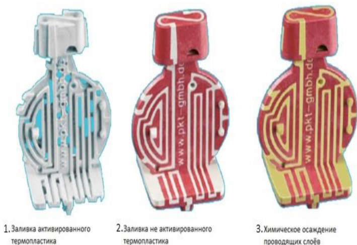
Рисунок 3. Последовательность технологических операций в технологии 2S
