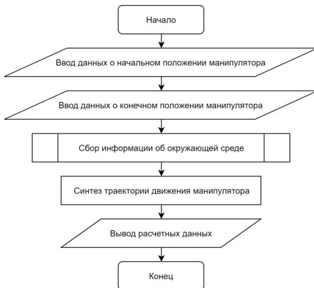
Рисунок 1. Обобщенная схема планирования траектории движения трехзвennого антропоморфного манипулятора в объемном пространстве с препятствием
